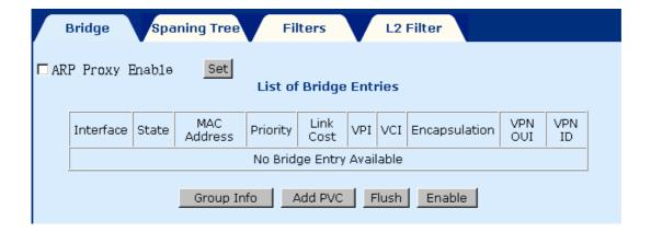
**ARP Proxy**: Vous pouvez activer la fonction ARP Proxy en cochant la case et en cliquant sur le bouton **Set**. Le proxy d'ARP permet au routeur de répondre à une requête ARP locale pour une destination distante. L'ARP (Address Resolution Protocol) (ARP) permet au routeur de déterminer l'adresse physique d'un hôte réseau en liant une adresse IP 32 bits à une adresse MAC 48 bits.
